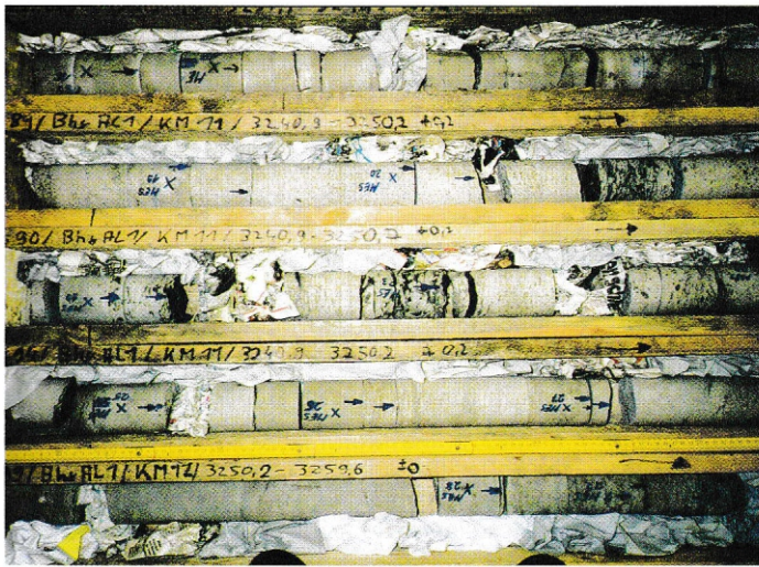
Abb. 3: Erbohrte Sandstein-Bohrkernabschnitte in Kernkisten (Foto: Dr. Baermann & Partner, Mikroanalytik)
